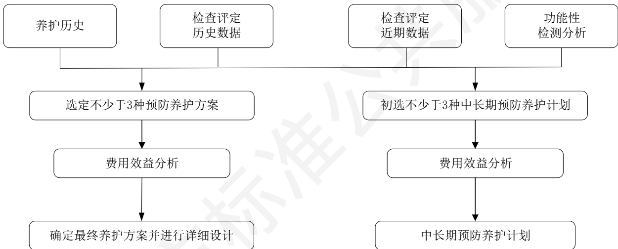
图 4 隧道土建工程预防养护设计流程图
